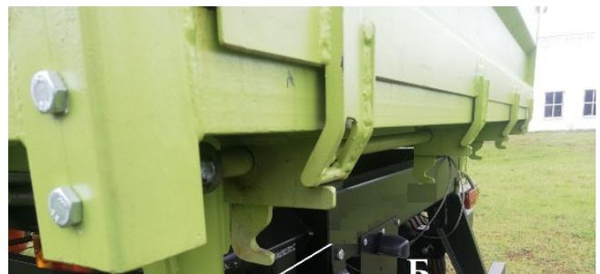
**Рисунок 5.2 Механизм нижнего открывания бортов**
