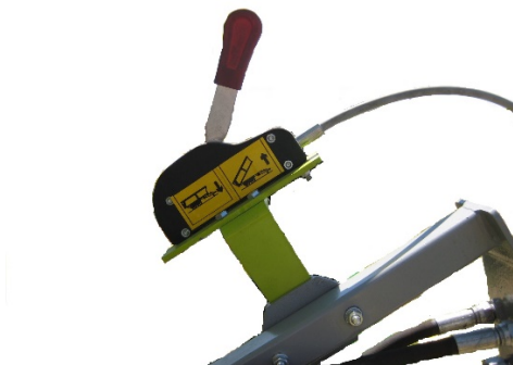
Рисунок 1.5 Рукоятка тросового управления гидрораспределителя
