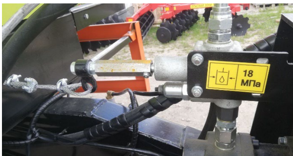
Рисунок 9.4.1 – Крепление троса ограничения угла подъёма кузова к клапану распределителя;
