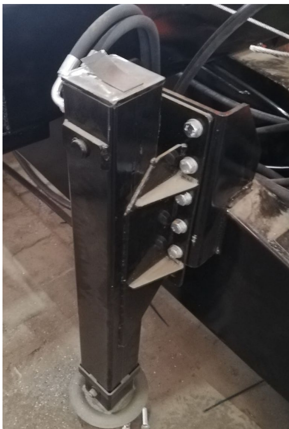
Рисунок 10.2 – Гидравлическая опорная стойка.
