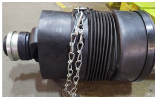
Рисунок 23б – Широкоугольный карданный вал с предохранительной и обгонными муфтами
