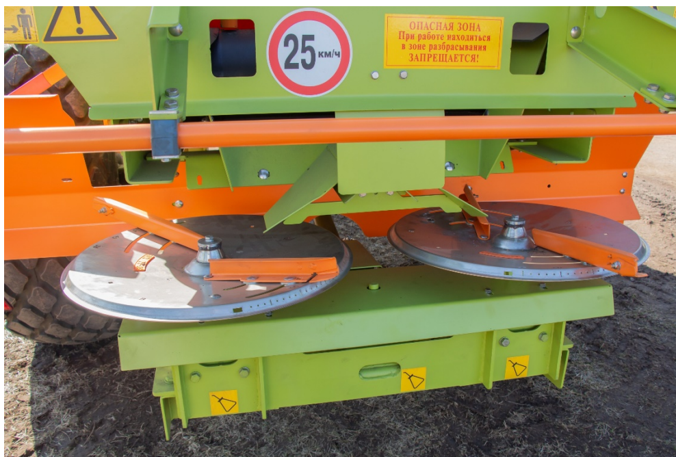
Рисунок 25 - Установка лопаток на тарелках по меткам
