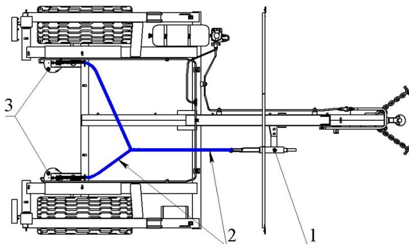
Рисунок 1.46 Стояночный тормоз полуприцепов ПСТ-6; ПСТ-6,5
